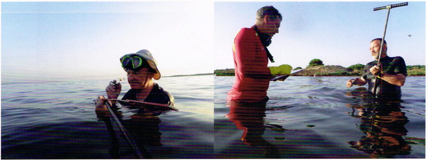
Abb. 4 Unterwasserbohrungen mit dem Hohlmeißelbohrer nach Dr. Pürckhauer. Ein Teil des Teams entnimmt mit dem Erdbohrstock Proben des Lagunenbodens zu bodenkundlichen und geomorphologischen Untersuchungen entlang der Bohrcatena C5, um die antike Topografie des Meeresbodens zu bearbeiten.
