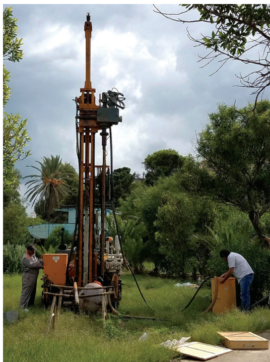
FIG. 13. – Opération de carottage mécanique rotatif, avec chemisage. Site de carottage CARTH V.
