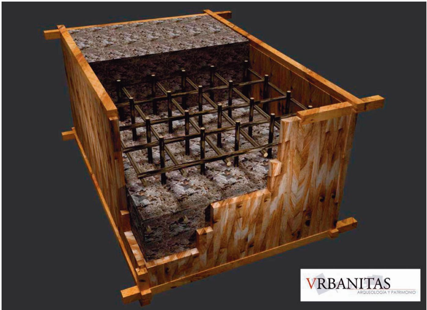
Fig. 15 – Restitución infográfica del esquema del encofrado (© Grupo Vrbánitas).
