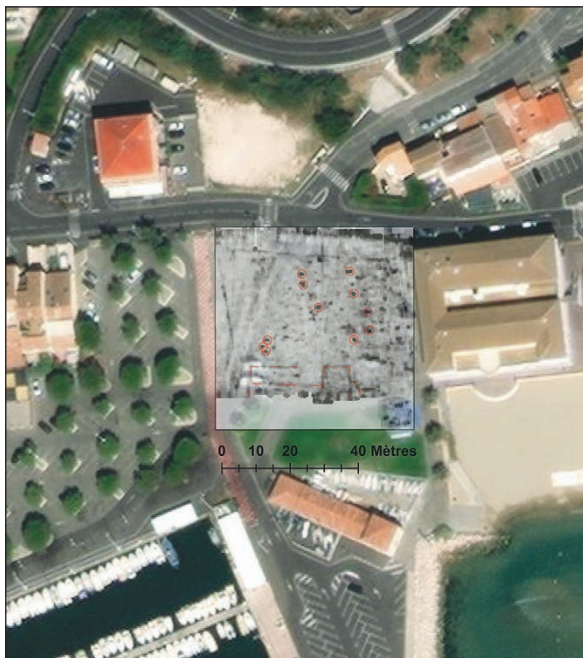
Résultats de la prospection au géoradar sur le parking de la Maison de la Mer. Profondeur : 0.4-0.8 m. Fréquence utilisée : 500 Mhz / Risultati della prospezione con georadar sul parcheggio della Maison de la Mer. Profondità 0.4-0.8 m. Frequenza : 500 Mhz (Ipsa Facto / Geopat / University of Southampton).
