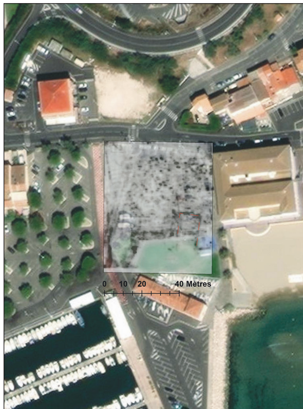
Résultats de la prospection au géoradar sur le parking de la Maison de la Mer. Profondeur : 1.2-1.6 m. Fréquence utilisée : 400 Mhz / Risultati della prospezione con georadar sul parcheggio della Maison de la Mer. Profondità : 1.2-1.6 m. Frequenza : 400 Mhz (Ipsa Facto / Geopat / University of Southampton).
