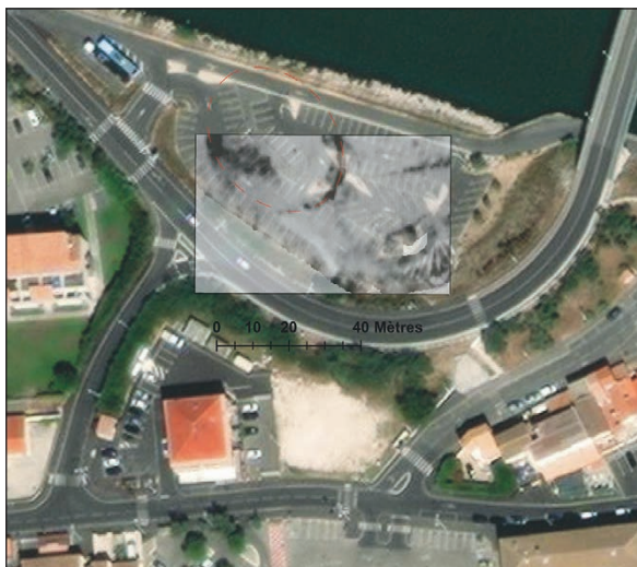
Résultats de la prospection au géoradar sur le parking de la Maison de la Mer. Profondeur : 0.4-0.8 m. Fréquence utilisée : 500 Mhz / Risultati della prospezione con georadar sul parcheggio della Maison de la Mer. Profondità 0.4-0.8 m. Frequenza : 500 Mhz (Ipsa Facto / Geopat / University of Southampton).
