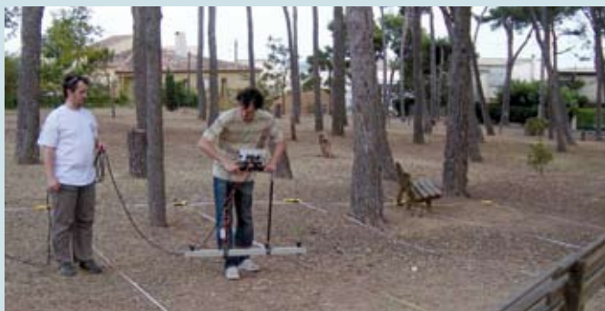
Prospections électriques dans la pinède de Port-la-Nautique © M. Druetz
