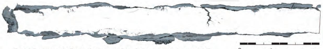
Fig 1 : Section métallographique 3 après polissage avant attaque Nital
