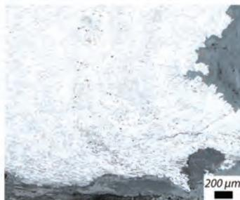
Fig 5 et 6 : La partie basse du poinçon se compose uniquement de ferrite, donc la partie la plus inférieure est écaillée. L'orientation des inclusions laisse présager d'un poinçon réalisé à chaud. Elles épousent les contours du poinçon et suivent le sens de déformation de la matière.
