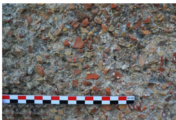
Fig. 14 : vue de détail des éclats de céramiques employées dans l'enduit de tuileau de BS5002 (cl. G. Duperron)
