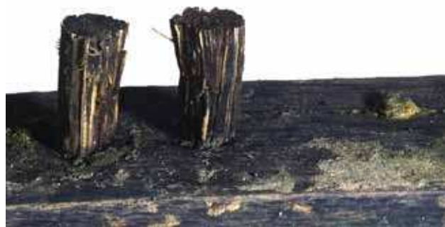
Fig. 5 – L'épave SM24 , vue de détail de son assemblage entre la membrure et le bordé par ligatures entre deux gournables (photo C. Durand, CCJ-CNRS).
