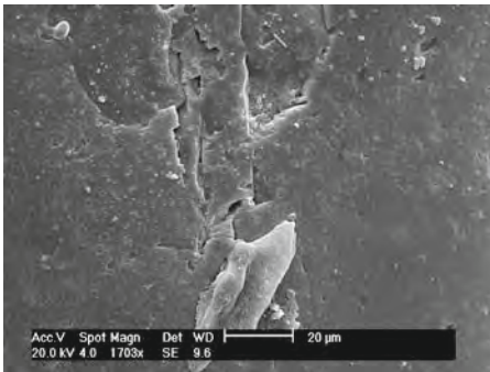
c) I - 9 SG: Traces de desquamation superficielles anciennes
