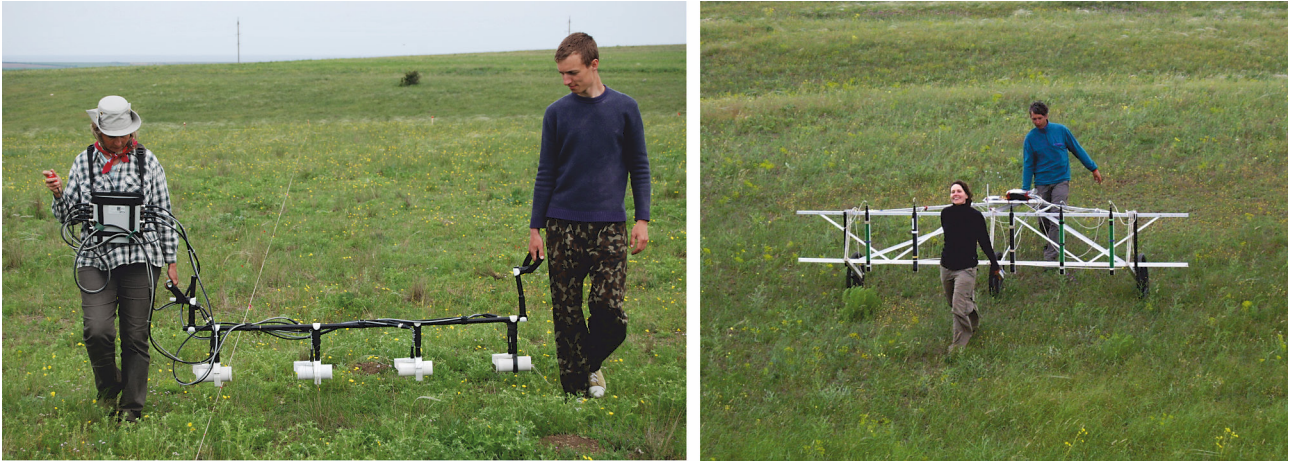
Figuur 6. Geofysica in het DSP. Links: Tatyana Smekalova en Andrei Chudin met de gedragen 4-sensoren-versie van de Overhauser GSM-19 totaalveldmagnetometer in 2008 (foto Peter Attema). Rechts: Dana Pils en Burkart Ullrich van Eastern Atlas met het mobiele fluxgate gradiometer systeem (foto Eastern Atlas).
