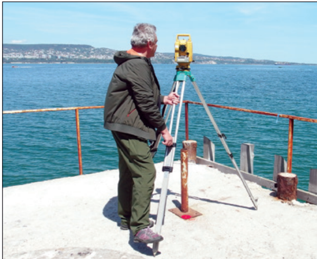
Fig. IX. 10. Working with a total station when mapping an ancient stone pier Работа с тотална станция при картиране на древен каменен кей
