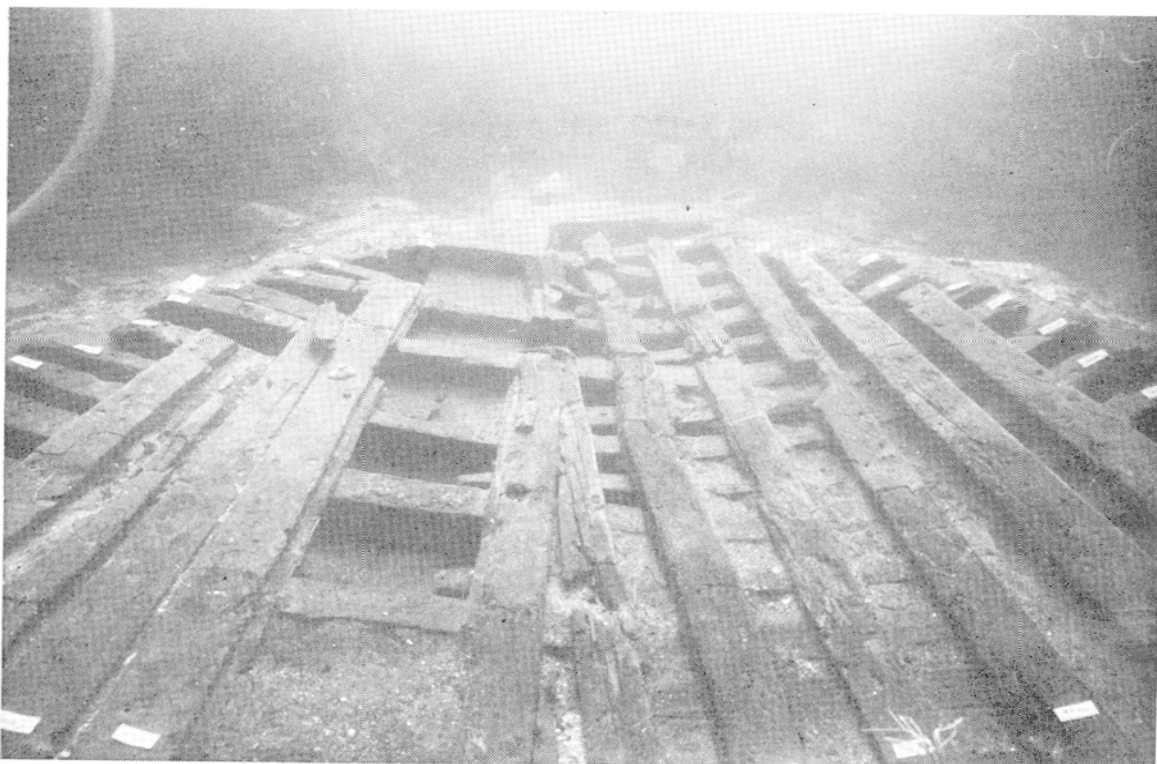
FIG. 1. Vue d'ensemble de la partie arrière de l'épave. Son bon état de conservation permet de bien discerner le resserrement progressif des flancs et la lente remontée des fonds en direction de l'extrémité. Dans l'axe, la forme des varangues souligne les fonds plats de cette partie de la carène. (Cliché G. Réveillac, CCJ, CNRS).
