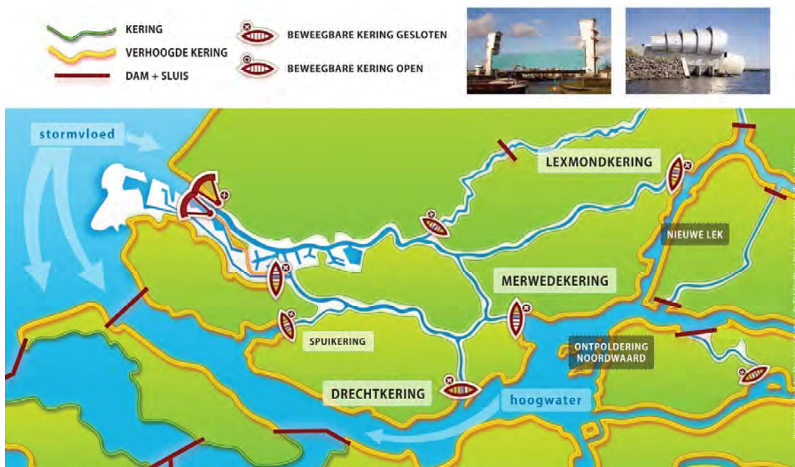
Figuur 3.6: De beweegbare keringen gaan alleen bij hoog water omlaag en beschermen daarmee steden als Rotterdam en Dordrecht, niet alleen binnendijks maar ook de buitendijkse gebieden. NB: voor Zeeland is aangenomen dat de Grevelingen en het Volkerrak rivierwater bufferen maar zonder extra dijkverhoging (tekening TU-Delft/HKV LJUN IN WATER ).
