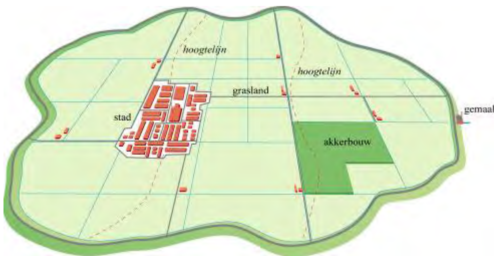
Figuur 1-1: Een schematisch overzicht van een polder. Kenmerkende elementen zijn het gemaal voor afvoer van overtollig water en de waterkering om de polder tegen 'buitenwater' te beschermen
