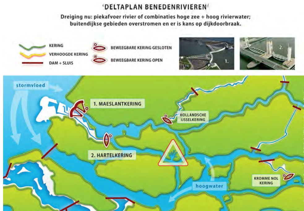
Figuur 6-2: Huidige situatie in het Benedenrivierengebied: bij combinaties van hoge waterstand op zee en de rivieren lopen de buitendijkse gebieden langzaam onder, en neemt de kans op een dijkdoorbraak toe (tekening TU-Delft / HKV LIJN IN WATER ).
