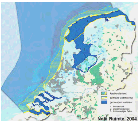
Figuur 1-11: Nederlands kuststelsysteem (bron: [Nota Ruimte, 2004]).
