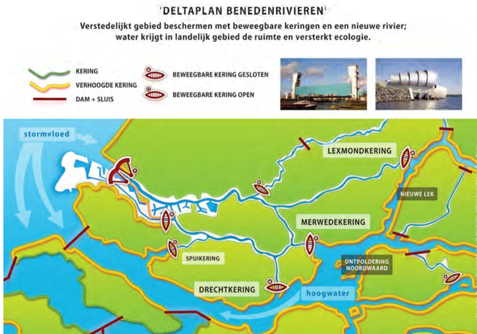
Figuur 6-4: Alternatief in het Benedenrivierengebied. De beweegbare keringen gaan alleen bij hoog water omlaag en beschermen daarmee steden als Rotterdam en Dordrecht, niet alleen binnendijks maar ook de buitendijkse gebieden. NB: voor Zeeland is aangenomen dat de Grevelingen en het Volkerak rivierwater bufferen maar zonder extra dijkverhoging (tekening TU-Delft / HKV LIJN IN WATER ).
