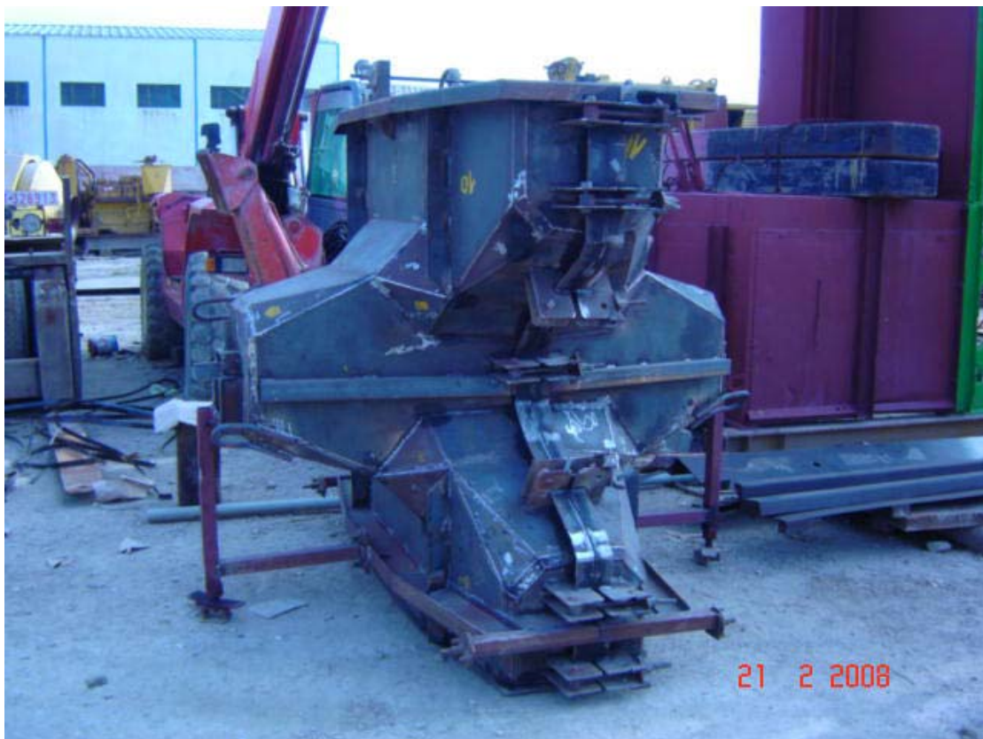
Photo N° 2 : Coffrage de 2.0 m3
