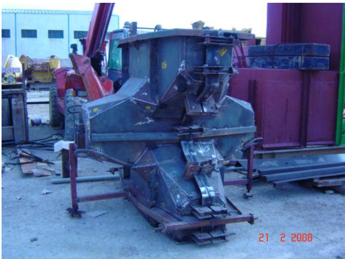
Photo N° 2 : Coffrage de 2.0 m3
