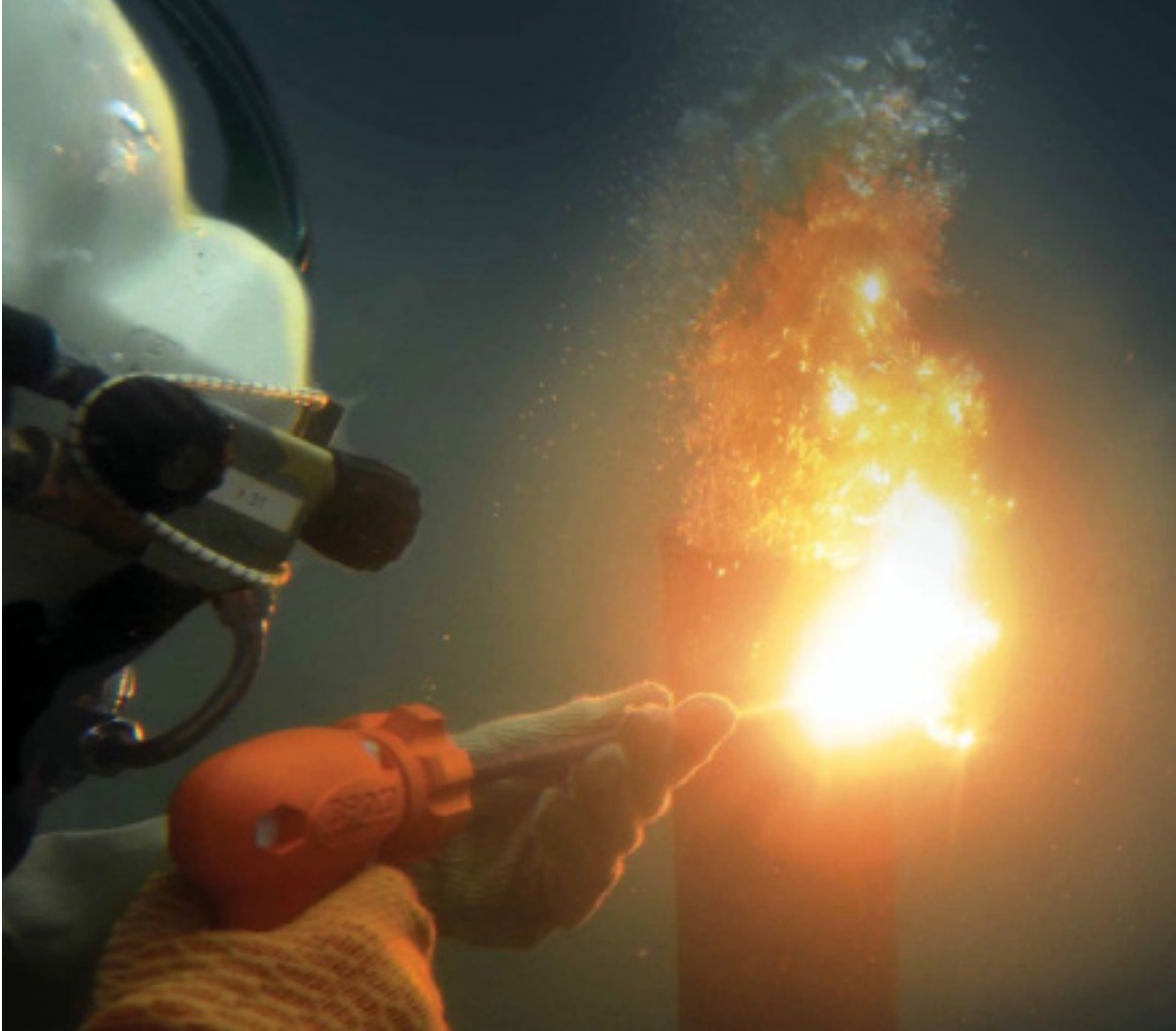
Resim 3: Sualtı kaynak/kesme sırasında biriken oksijen ve yanıcı maddeler patlamaya sebep olur.
